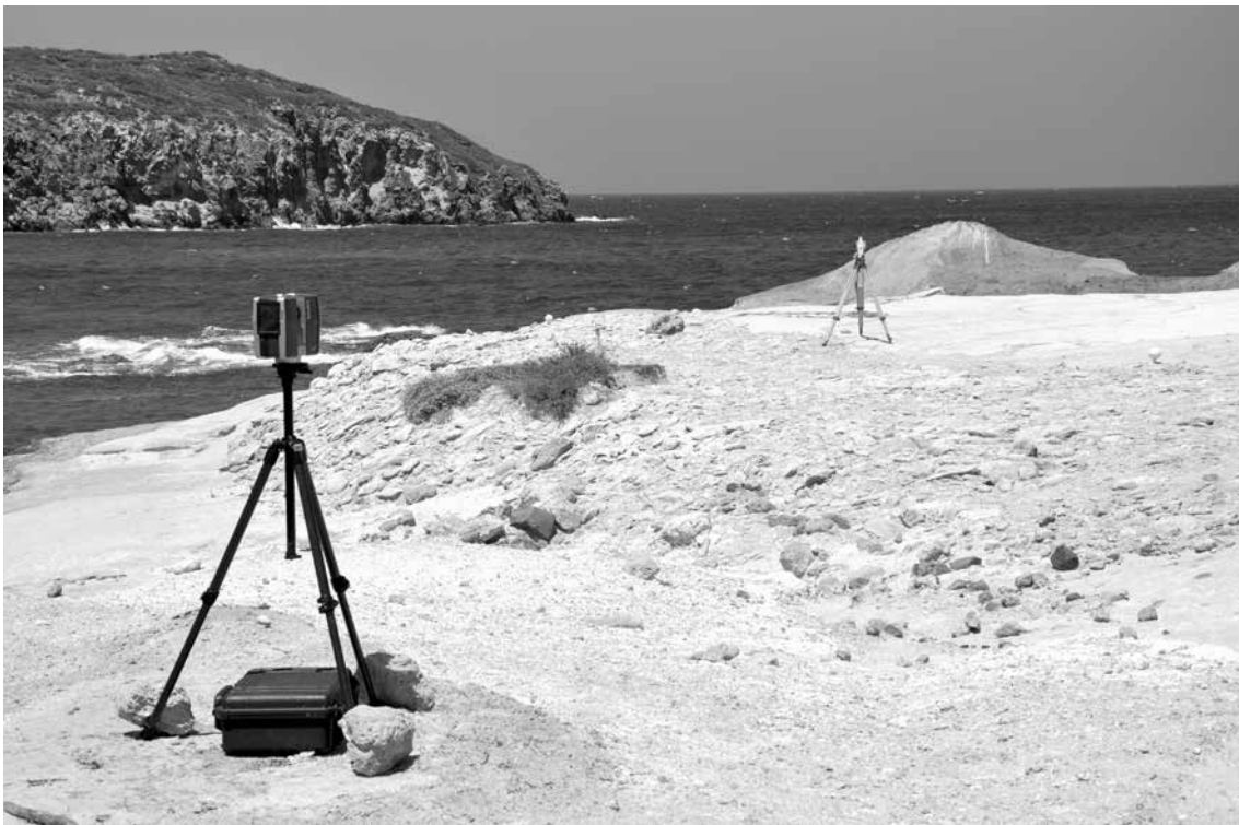
Fig. 35 - Una fase del rilievo 3D con laser scanner Faro Focus3D e il supporto di misure con stazione integrata.
