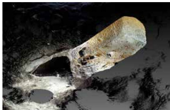
Fig. 21 - Vista inclinata 3D della nuvola di punti a colori della porzione del modello globale dell'area del vertice 201 e dettaglio della morfologia 3D dell'ipogeo funerario K201 (Elaborazione grafica: M. Monego).
