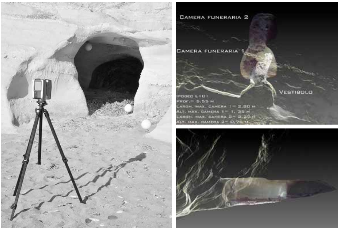
Fig. 25 - Ipogeo funerario L101. Stato attuale dell'area del vestibolo di accesso (a) e viste dall'alto (b) e laterale (c) della nuvola di punti a colori della tomba a camera. Sezioni estratte dal modello 3D (Elab. grafica: M. Monego).
